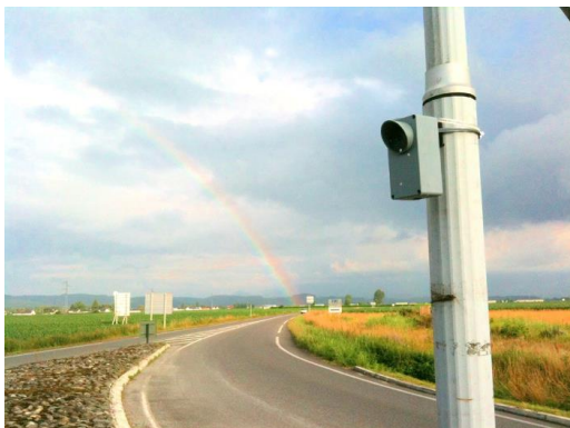
Exemple de caméra d'enregistrement utilisée pour les comptages directionnels
